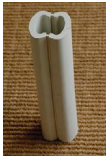
Gebrennte, unglasierte Fassadenfliesen mit Abstandhalter respektive «Back to Back» zur Stabilisierung beim Brennvorgang. Bilder: Susanna Anttila
